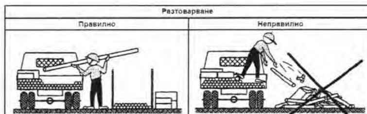
Фиг. Схеми за разтоварване
