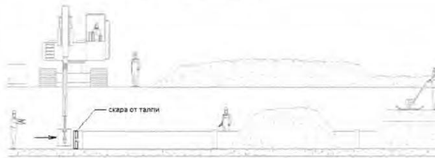
СХЕМА 6 - Притискане на новата тръба
