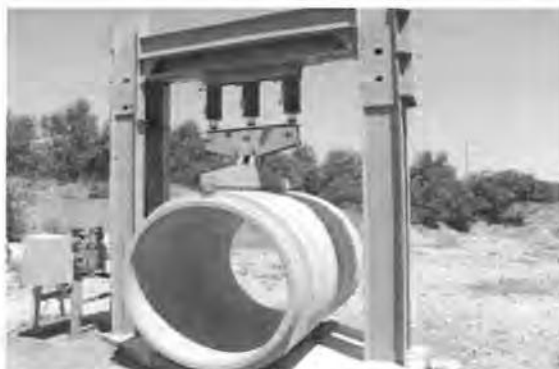
Снимки 1-1: Изпитване на носимоспособност на тръбите
