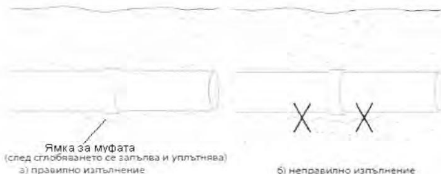
Фиг. Изпълнение на ямки за муфите
